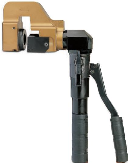
Attrezzatura oleodinamica manuale idonea a forare senza preforo canali portacavi in metallo o in materiali plastici. Il movimento satellitare della testa perforatrice consente forature su canali installati a soli 16 cm dalla parete. È dotata di una valvola limitatrice di pressione, atta a salvaguardare l'attrezzo da eventuali utilizzi anomali. I materiali utilizzati per costruire la testa consentono di contenere il peso dell'attrezzatura in soli 3 kg.
