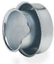
Accessori terminali realizzati in lamiera deformata. Sono applicati per avvitamento alle estremità dei tubi metallici pieghevoli per evitare il contatto tra i cavi e gli spigoli del tubo.
