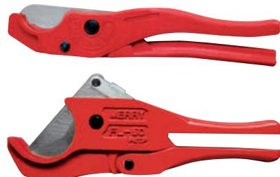
Appositamente studiate per il taglio dei tubi flessibili plastici, queste robuste cesoie realizzano tagli netti e senza sbavature, requisiti fondamentali per il corretto assemblaggio tubo-raccordo e della tenuta stagna del sistema. Disponibili anche le lame di ricambio.
