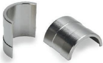
Accessori in ottone nichelato, vengono utilizzati come soluzione tecnica nei tubi flessibili in poliammide protetti da treccia metallica. Sono costituiti da due semigusci cilindrici opportunamente sagomati al fine di inserirsi nell'ondulazione del tubo ed impedirne lo scorrimento assiale. Vengono collocati nella parte terminale del tubo sia come protezione dalle forature accidentali che per l'applicazione di una fascetta con vite di terra senza deformare il tubo.
